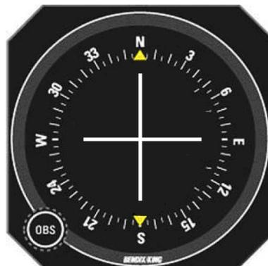
*L'avion est pile dans l'axe de la piste et sur le bon plan de descente.*
